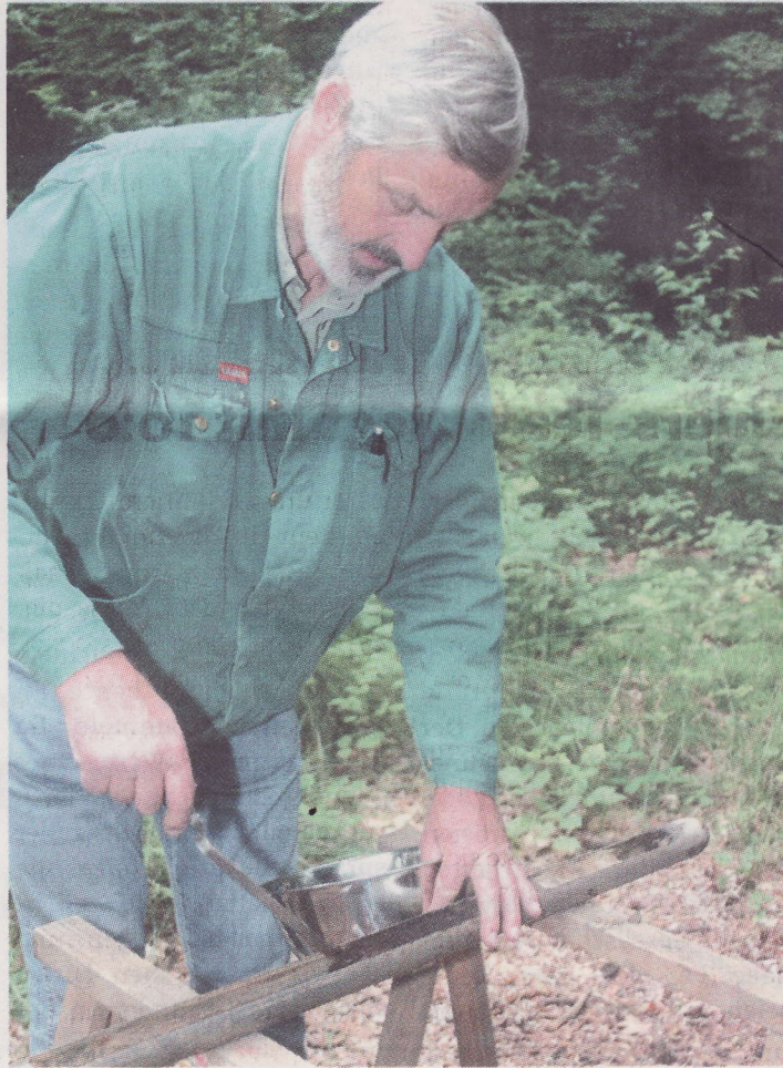
Johann Wolfgang Scheel vom „Analytik Labor Nord“ demonstriert das Entnehmen einer Bodenprobe aus einer Rammkernsonde.
